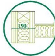
Couverture en EPDM Garantie 30 ans. Isolation toiture de 200 mm. Epaisseur totale du complexe : 316 mm.
