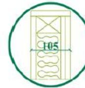
Cloisons intérieures en ossature bois. Epaisseur de 105 mm. Isolation incluse
